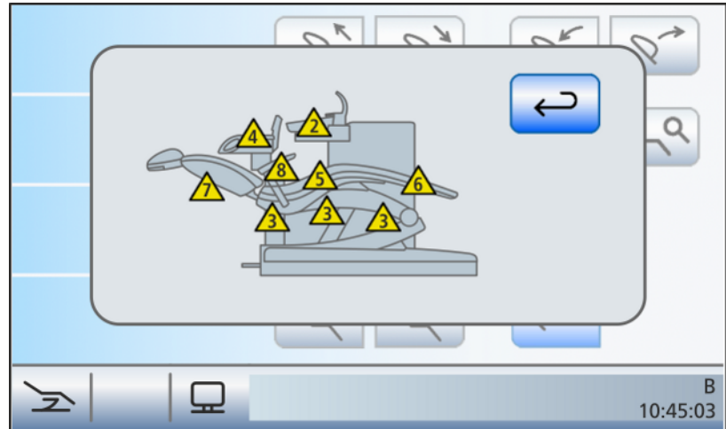
Affichage des interrupteurs de sécurité déclenchés (tous sur la même vue)
