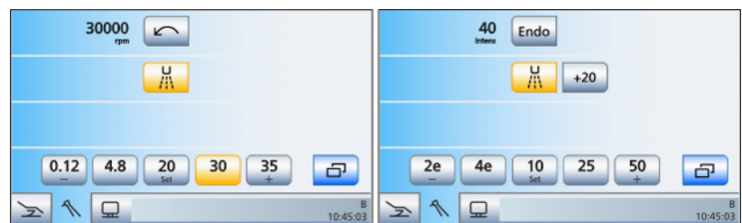
Boîte de dialogue Moteur (vitesse) et boîte de dialogue Ultrasons (intensité) avec touches de réglage rapide programmables
